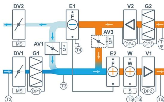
Для регионов с жарким и влажным климатом возможно использование теплового насоса в реверсивном режиме для охлаждения воздуха с выносным конденсатором (опция CE). Также возможно оснащение установки фреоновым охладителем и выходом для управления ККБ (опция CF).
