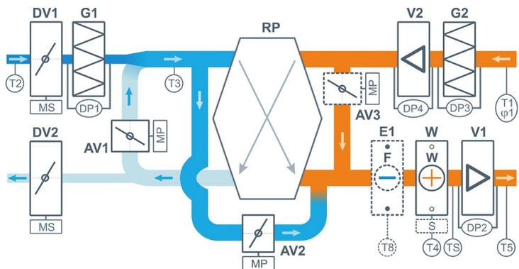
Для регионов с жарким и влажным климатом возможно оснащение установки фреоновым охладителем и выходом для управления ККБ (опция CF).
