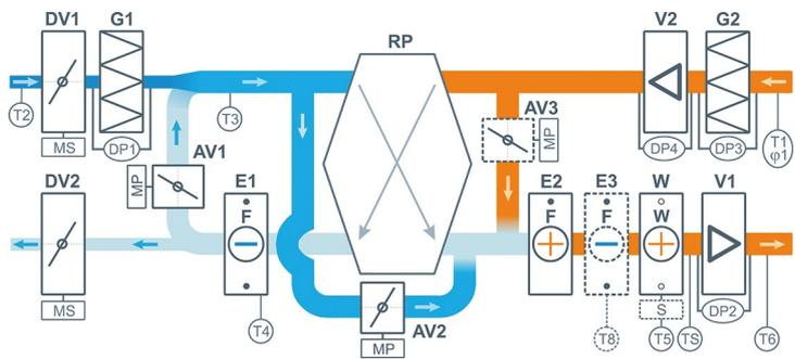
Для регионов с жарким и влажным климатом возможно использование теплового насоса в реверсивном режиме для охлаждения воздуха (опция CH), в том числе с выносным конденсатором (опция CE). Также возможно оснащение установки фреоновым охладителем и выходом для управления ККБ (опция CF).
