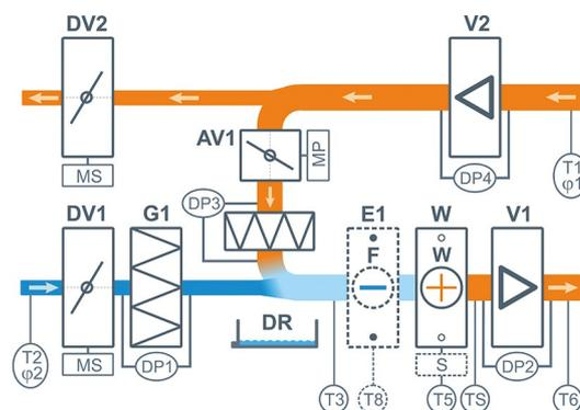
Для регионов с жарким и влажным климатом установка может комплектоваться фреоновым охладителем, работающим в режиме охлаждения и осушения приточного воздуха, а также выходом для управления ККБ (опция CF).
