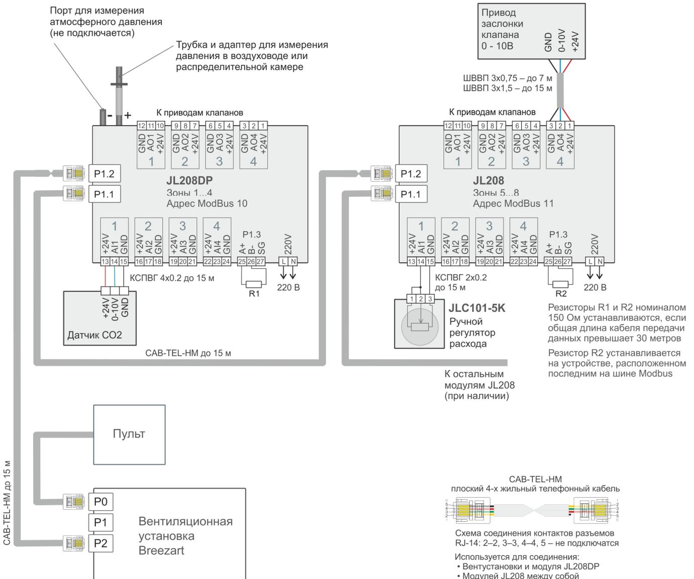
Тип и максимальная длина кабелей указаны на схеме, допускается использовать аналогичные кабели с таким же или большим сечением.
