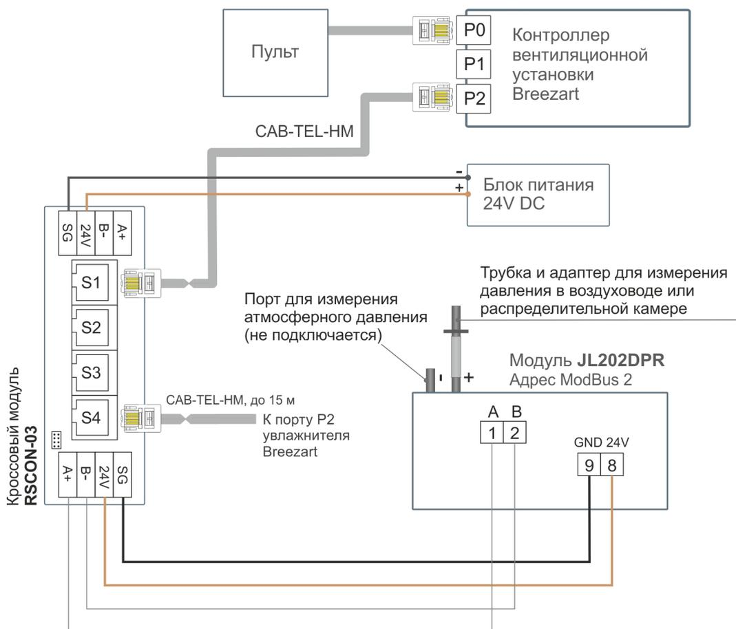
После сборки VAV системы в соответствии со схемой, настройте систему по инструкции [http://www.breezart.ru/tech/setting\\_vav\\_breezart.pdf](http://www.breezart.ru/tech/setting_vav_breezart.pdf)
