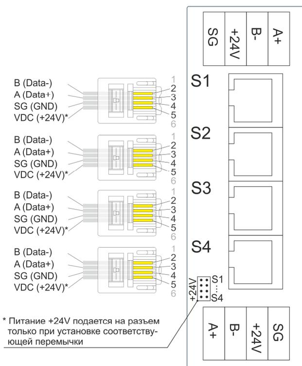
\* Питание +24V подается на разъем только при установке соответствующей перемычки
