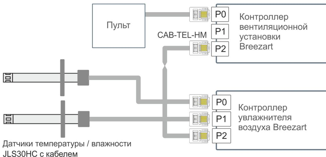
Один или два датчика влажности / температуры JLS30HC подключаются к портам P0 и P1 увлажнителя.
