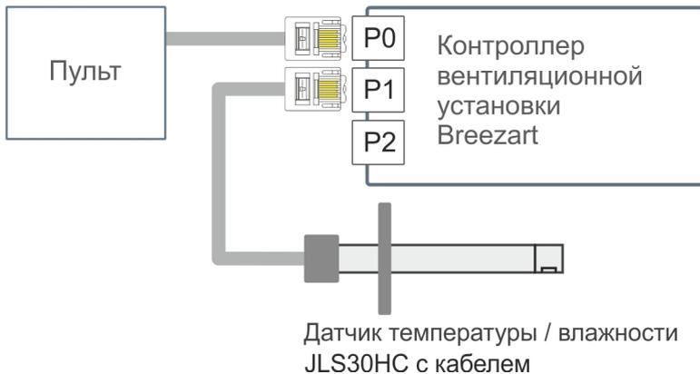
**Вариант 2.** Подключение к вентустановке двух цифровых датчиков температуры / влажности производится через кроссовый модуль RSCON-03 (можно подключать как к порту P1, так и к P2). При подключении к порту P2 дополнительно требуется блок питания 24В (этот порт не имеет питания). При подключении к порту P1 питание на RSCON можно подать от порта вентустановки.
