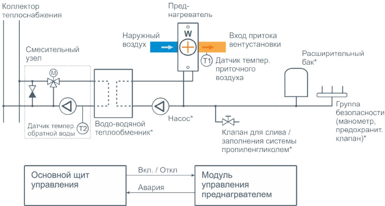
Схема подключения дополнительного калорифера для преднагрева воздуха на входе в вентустановку до температуры -15°C (для регионов с холодным климатом).
